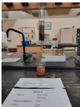
Figura 1: Columna con diferentes suelos que simula un tecnosuelo y agua contaminada
