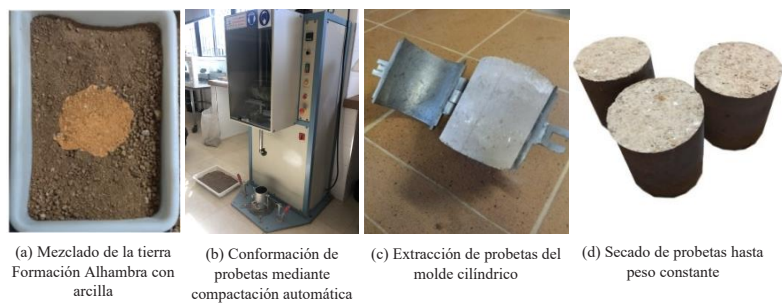
Figura 1. Proceso de conformación de probetas de tierra.
